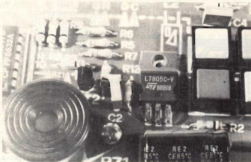
cere di qualche millimetro (i due terminali di collegamento estremi fanno infatti da perno e da guida); trovata la posizione ideale si inseriranno, negli altri 6 punti di IC2 numerati con 2, 3, 5, 12, 13 e 15, i rimanenti terminali di collegamento che, una volta ben saldati, conferiranno solidità e compattezza all'insieme. Ricordare che, per ciascuno degli 8 terminali, sono necessarie due saldature: una superiore con la lastrina di IC2, e una infe-
