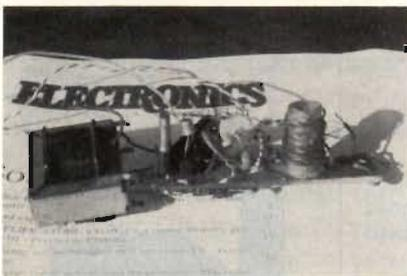
Il trasmettitore montato "velocemente".
